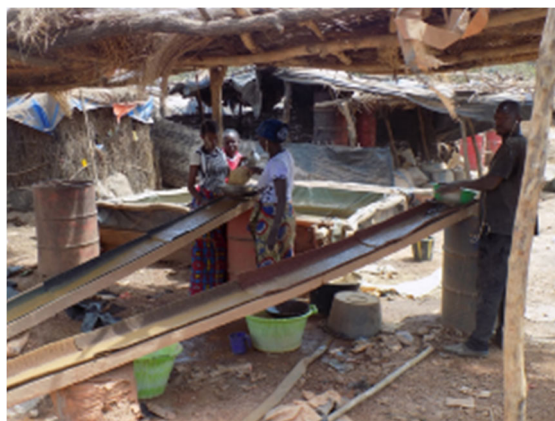
Photo ASFA21 : travaux d'amalgamation et de cyanuration sans protection appropriée
